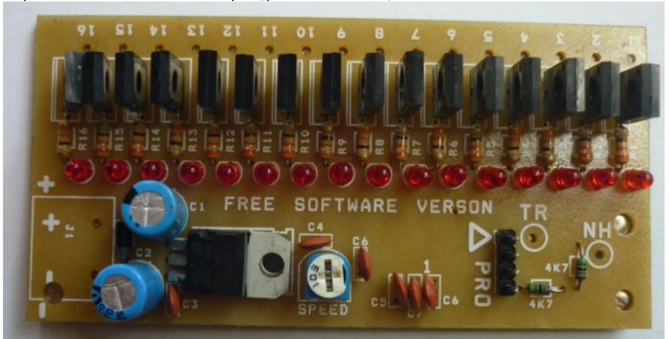
Hình 4: Board điều khiển led 16 cổng lắp linh kiện hoàn chỉnh (mặt trên)
